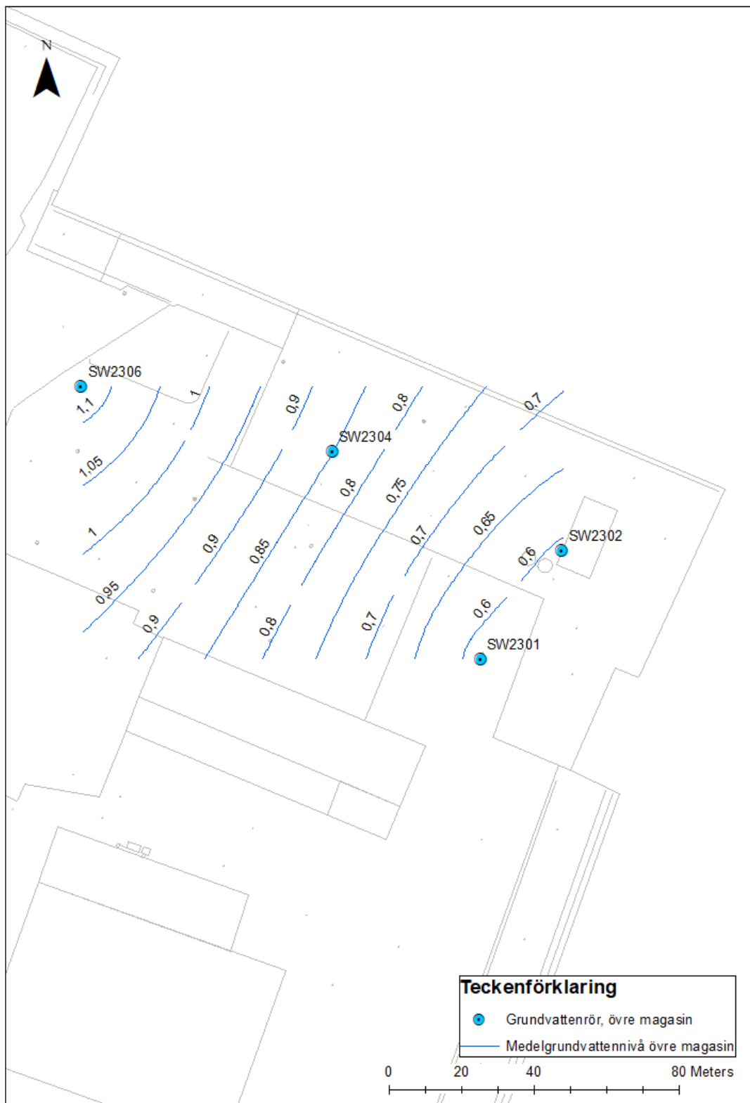
Figur 9. Kartbild med grundvattenrör på Hugo Hammars kaj i övre magasin och interpolerad medelgrundvattennivå i övre magasin baserat på mätningar utförda november 2023 till januari 2025.
